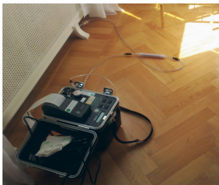
Radoninstrument Rad 7 direktvisande radoninstrument indikerar både radon och Thoron. Thoron indikerar markradonläckage.
